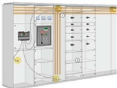
MDmax开关柜中，可选择安装弧光传感器。当弧光控制系统探测到故障电弧产生时，将向断路器发出脱扣信号。这种情况的探测反应时间为1毫秒。而从短路弧光被监测到的瞬间到断路器断开故障回路的时间仅为35至45毫秒，极大的限制了故障电弧产生的危害，挽救生命，减少设备损坏。
