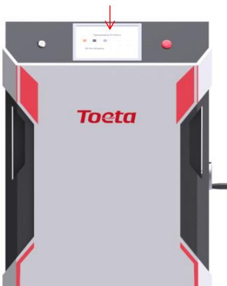
4. 在电量充足状态时按下操作按钮，服务小车随机做上升和下降运动，轻点对应箭头，小车将自动持续上升或下降，直至下一个相反命令停止，任何情况下按下急停按钮，升降操作立即停止，顺时针旋动急停按钮使其跳起，操作功能恢复。
